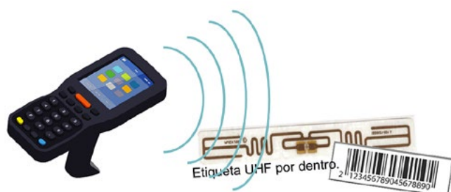
Figura 3: Un lector de RFID-UHF tipo handheld y vista interior y exterior de una etiqueta UHF adhesiva usual en la industria del retail.
